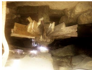
トルトック村の水車は8枚W羽根
