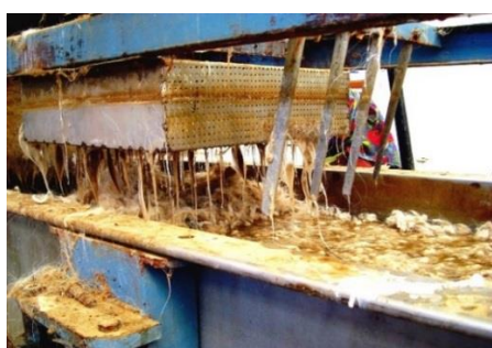
各地から集まってきた羊毛原糸は何回も洗浄を行います。
